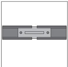
Montage med **Skarv Rak / Skarv L** för enkel sammanlänkning av flera profiler. Skjut i skarven i profilen, fixera skarven genom att skruva åt låsskruvarna.
